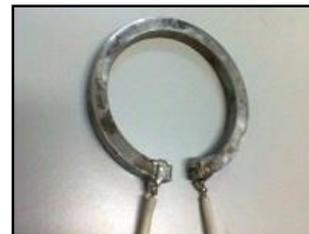
Fig. 6. Anel segmentado com terminais para medida da resistividade elétrica.
