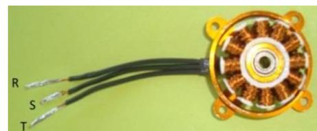
Fig. 12. Estator do mini motor instalado na carcaça.
